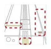
架空で配線されている電 線類を電線共同溝に入溝 します。
