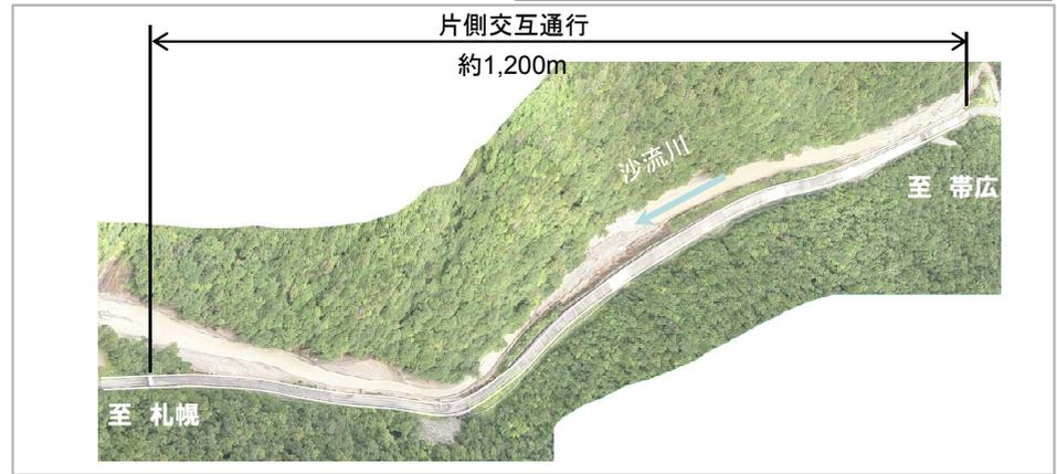
➤ 切土法面崩壊、盛土崩壊および道路本体が大きく欠損した箇所(室蘭側日勝峠7合目)では、2車線を確保し、対面通行による開通を行う予定。
