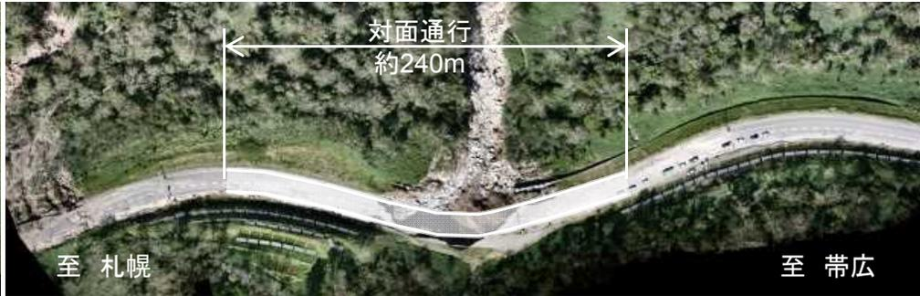
➤ 帯広側の切土法面崩壊箇所と盛土崩壊箇所では、2車線を確保し、対面通行による開通を行う予定。
