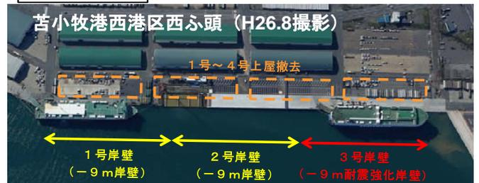
※写真は3号岸壁が完成し2号岸壁を工事中の写真。現在は2号岸壁も完成し1号岸壁を工事中。
