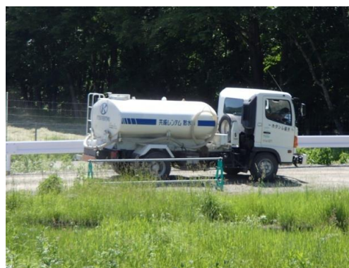
粉じんの低減 (非舗装路面への散水)
