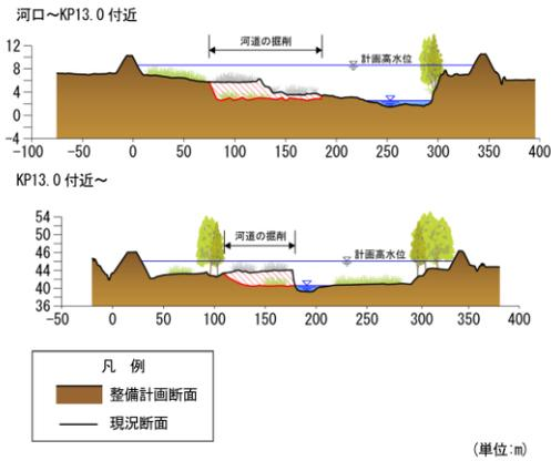
図 2-2 河道の掘削のイメージ図
