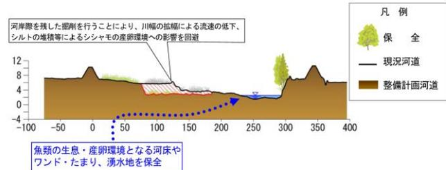
24 図 2-8 河道掘削のイメージ図
