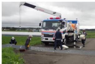
写真 2-1 ポンプ車による内水排除の状況
