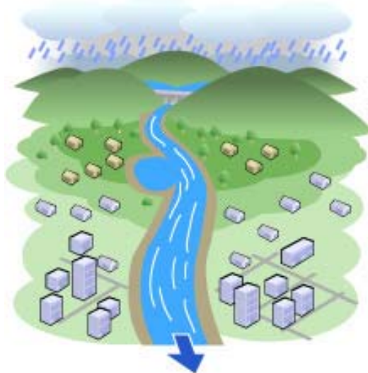
降った雨の一部をダムや調節池で カットした後の流量
