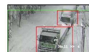
AIを活用したカメラ画像解析により冬期道路の車両滞留の自動検知(イマージ)
