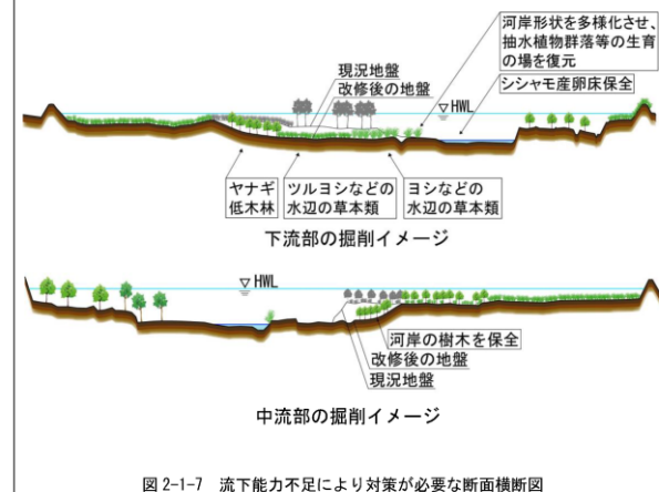
図 2-1-7 流下能力不足により対策が必要な断面横断面図
