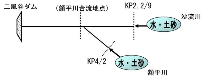
図-1.8 二風谷ダム再現計算の概要図
