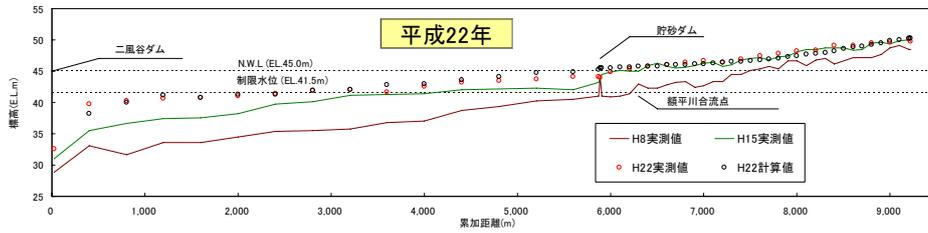
図-2.18 平成22年二風谷ダム（沙流川）平均河床高
