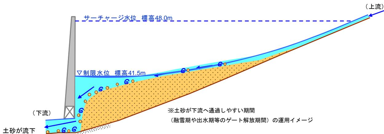
図-1.3 二風谷ダム土砂通過のイメージ
