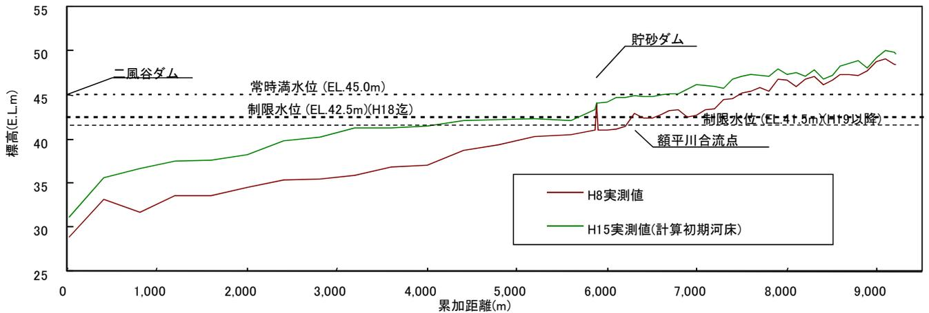
図-2.11 沙流川縦断面図(平成8年, 平成15年 実測値)
