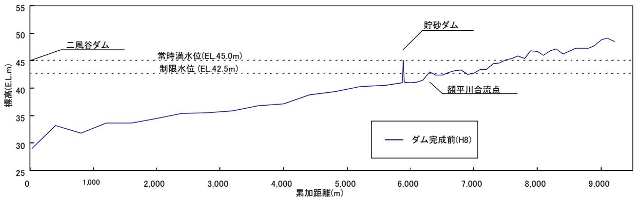
図-1.9 沙流川縦断図（平成8年実測値）
