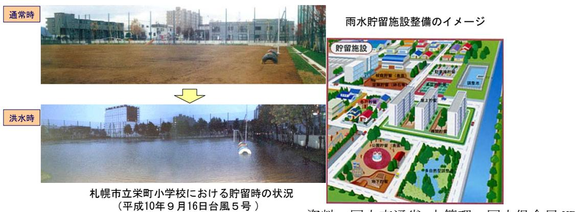
図 4.2-13 雨水貯留施設のイメージ
