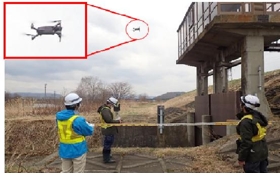
AI 技術による樋門等構造物の変状確認・評価
