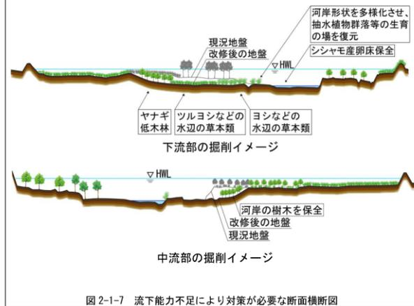
図 2-1-7 流下能力不足により対策が必要な断面横断図
