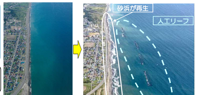
白老工区人工リーフによる砂浜の再生(左:着手前、右:整備後)
