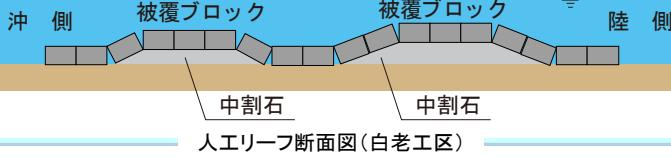
人工リーフは、海岸に襲来する高波を冲合で弱め、海岸侵食や越波を低減させる施設です。近年、右の写真のように人工リーフ背後の海岸線に砂浜が再生していることが確認されています。
