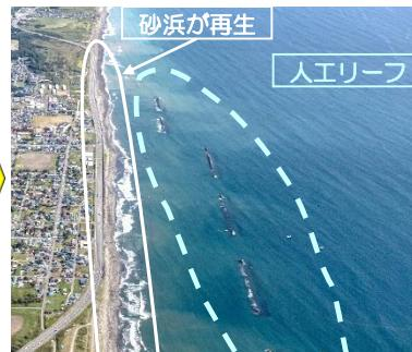
白老工区人工リーフによる砂浜の再生（左：着手前、右：整備後）
