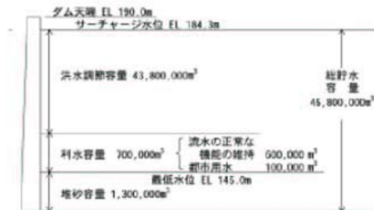
図 2-1-5 平取ダム貯水池容量配分図
