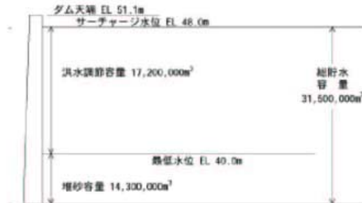
図 2-1-6 二風谷ダム貯水池容量配分図
