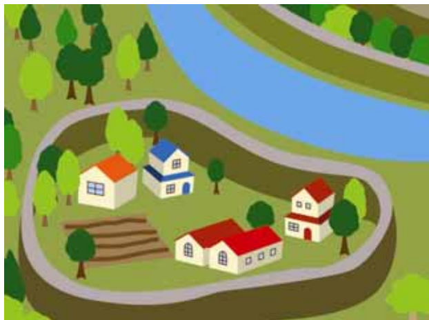
輪中堤：特定の区域を囲むように作られた堤防
