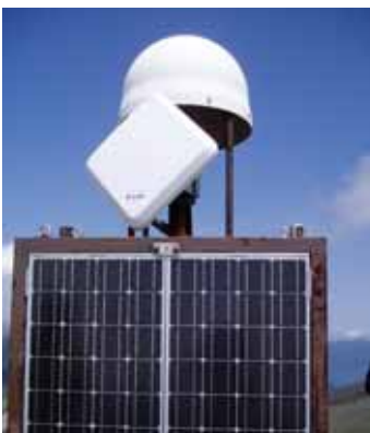
地下のマグマの動きをとらえる地殻変動を観測するGPS
