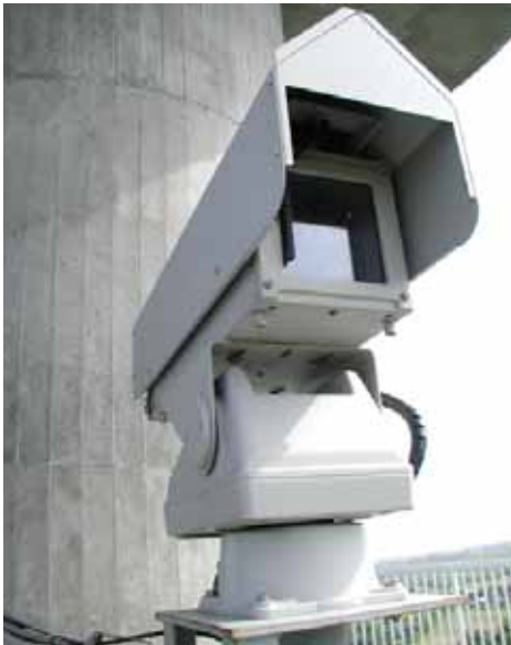
監視カメラ(別々川に設置)
