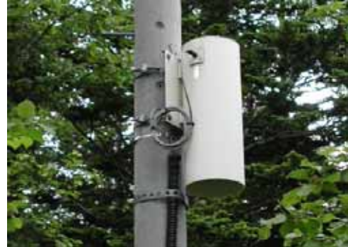
空振計(噴火による空気の振動をとらえる装置)
