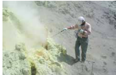
噴気孔の温度測定
