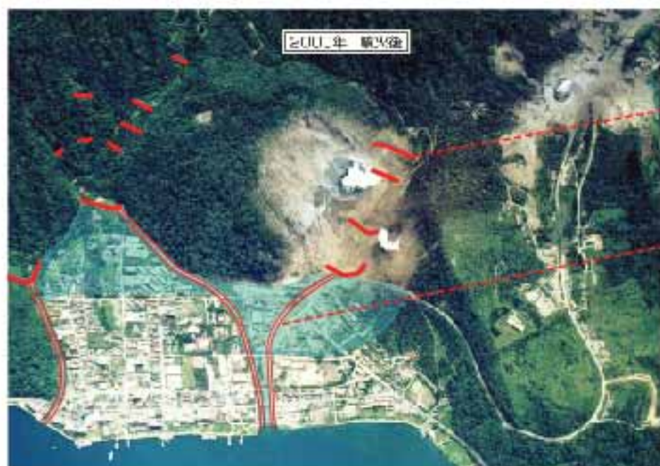
1977年噴火後に作られた砂防施設(赤い線)と2000年噴火後に作られることになった砂防施設の区域(青い範囲)
