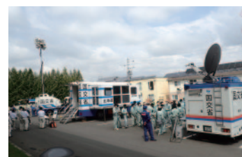
帯広工業高校での災害対策用機械を用いた防災教育(写真左から照明車、対策本部車、衛星通信車)
