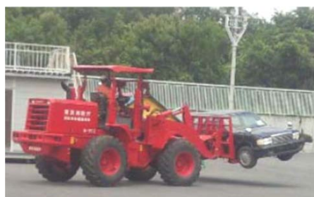
車両移動のための具体的対策 例:ホイールローダーによる移動
