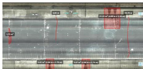
覆工展開画像から損傷図を作成
