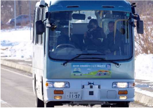
路面に埋設した磁気マーカの読み取りによる自動走行(運転手不在)
