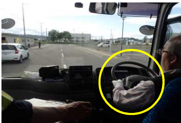
ドライバーが駐車車両を回避するハンドル操作に介入
