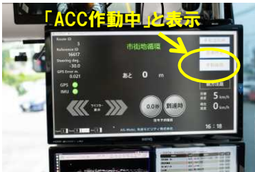
接近回避のため、走行システムが自動で減速
