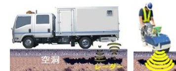
路面下空洞調査
