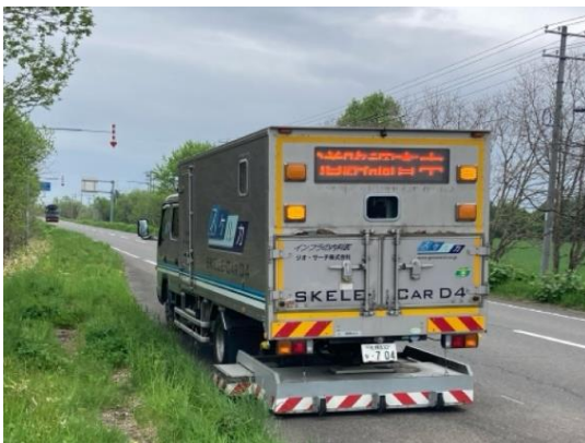
路面下空洞調査状況
