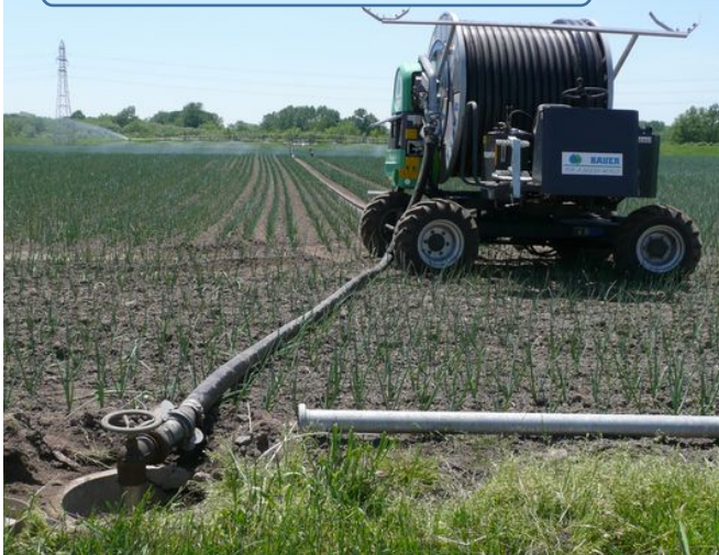
給水栓とリールマシンの接続
