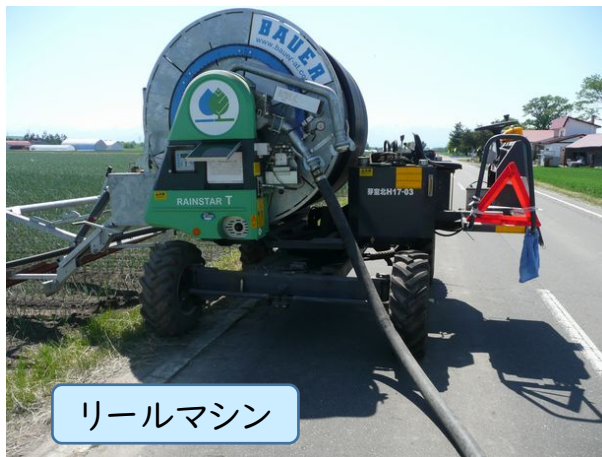
レインガン方式(散水幅 60m程度)
