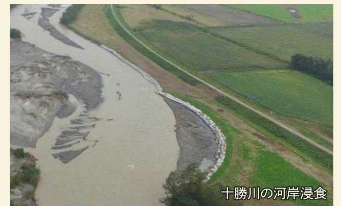
音更川の低水護岸流出
