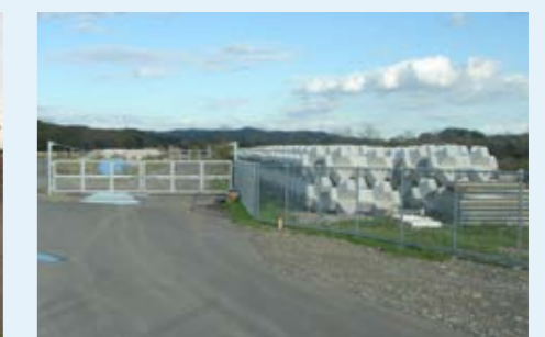
水防資材の備蓄(根固めブロック)
