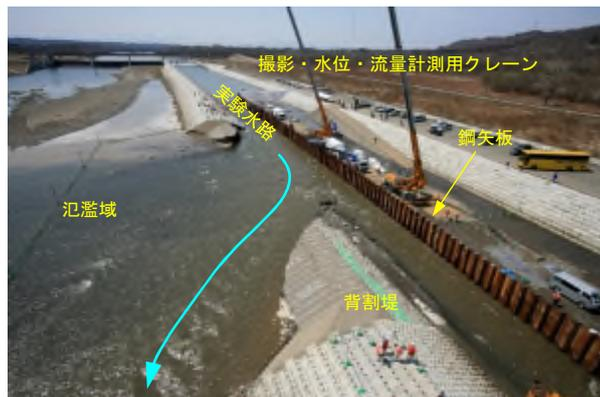
平成22年 越水による堤防決壊実験の状況
