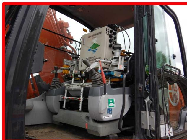
簡易遠隔操縦装置
