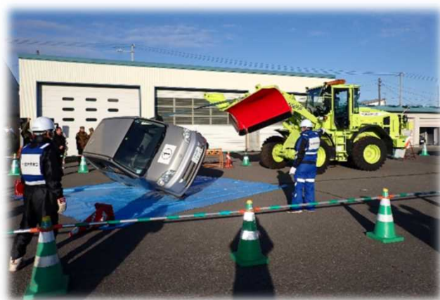
除雪トラックによる横転車両移動 (引き出し作業)
