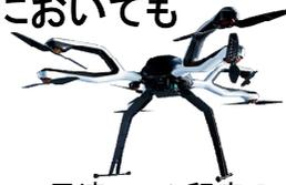
風速20m/s程度の強風下で飛行可能
