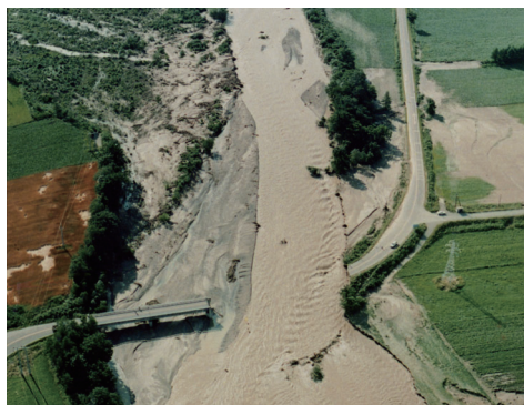
然別川 流出した鹿追橋と農地の欠損 (昭和 56 年 8 月 3 日～ 6 日)
