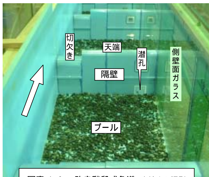
写真 4-2 改良階段式魚道 上流から撮影
