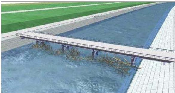
研究事例1) 橋脚による流木閉塞メカニズムの解明
