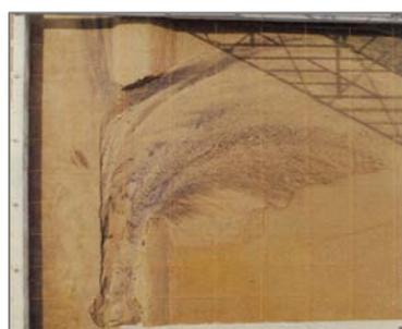
縮尺模型実験の破堤後状況
