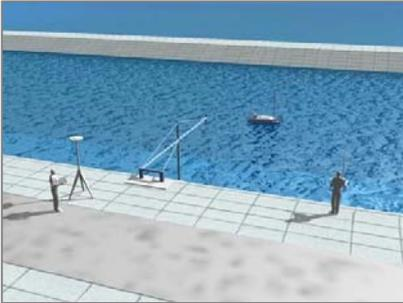
杭ワイヤー式ADCP観測船とRCADCP観測船風景
