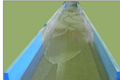
模型実験による河床波発生実験例
