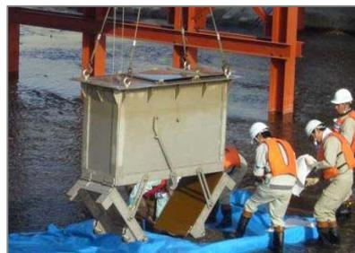
バケット式掃流砂採砂器
