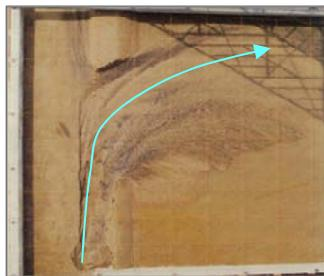
縮尺模型実験の破堤後状況
