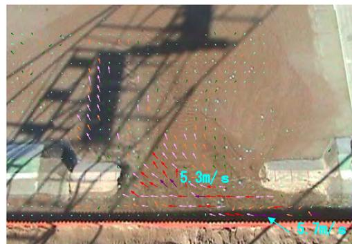
模型 C1-2, 破堤幅 43m
