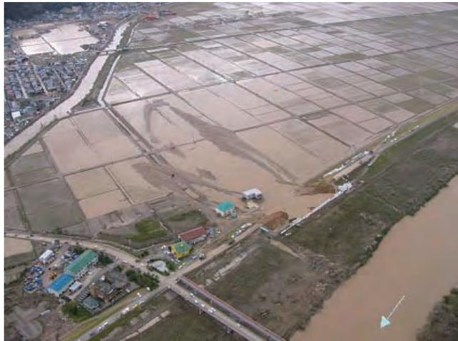
図-1 円山川の破堤状況(国土交通省 HP より)
