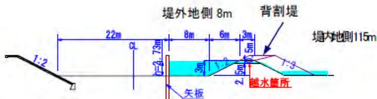
図 41 実験水路断面形状，底幅 8m の場合
