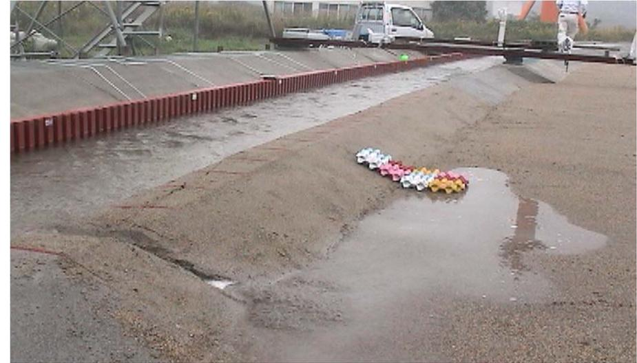
破堤幅 ≒ 32m (t=77.5min)
