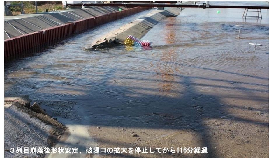
3列目崩落後形状安定、破堤口の拡大を停止してから116分経過
