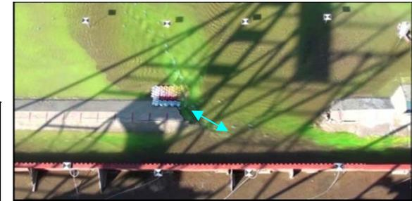
例) 本実験Case5の場合の表面流速PTV計測箇所
