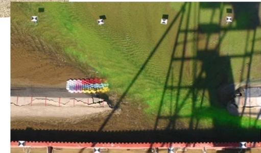
破堤口幅45mの状況
