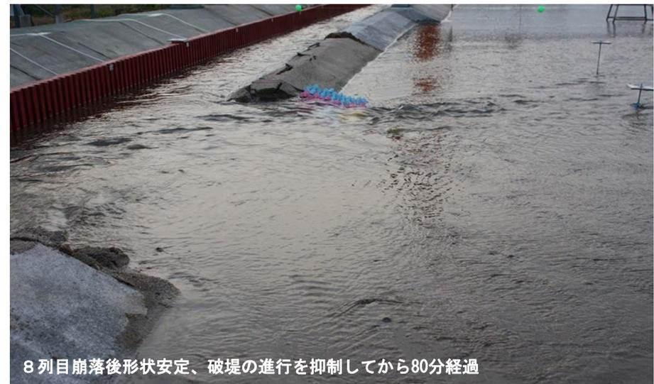
8列目崩落後形状安定、破堤の進行を抑制してから80分経過
