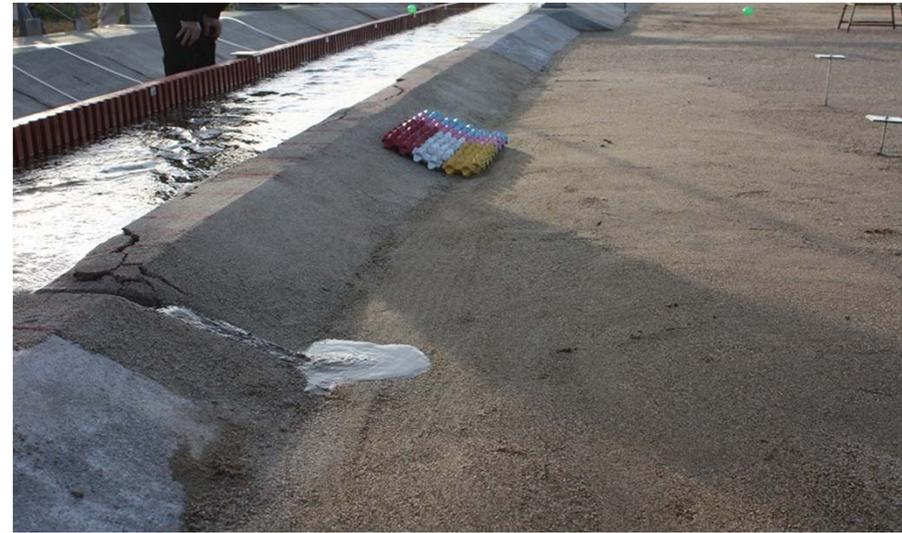
破堤幅 ≒ 35m (t=102min)
