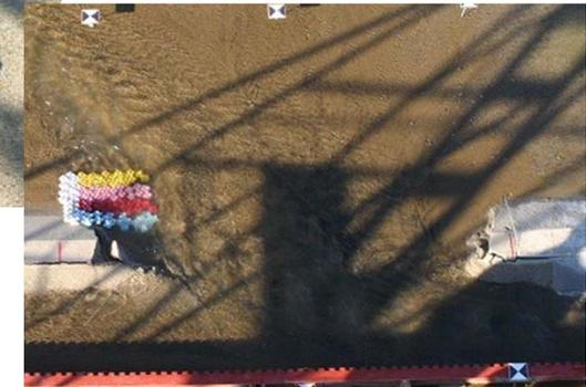
ブロックによる破堤口拡大抑制状況
