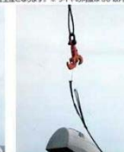
吊り荷が所定の位置に着地 (負荷がなくなったため、フックは自動的に解除)
