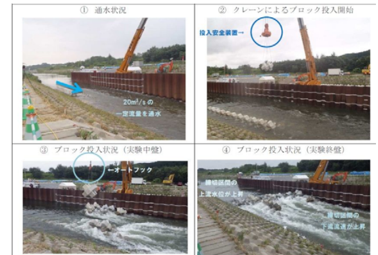
C. 実験水路横断締切実験
