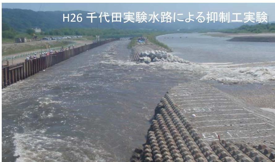
H26 千代田実験水路による抑制工実験
