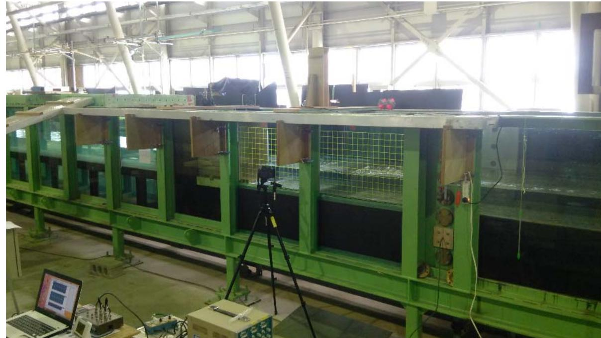
ブロック前後断面の流速分布を測定
