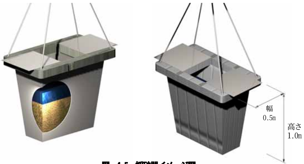
図-4.5 採砂器イメージ図
