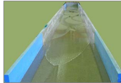
模型実験による河床波発生実験例
