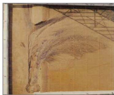
縮尺模型実験の破堤後状況 (土研資料: 樹林帯による破堤後の減災効果に関する検討より)
