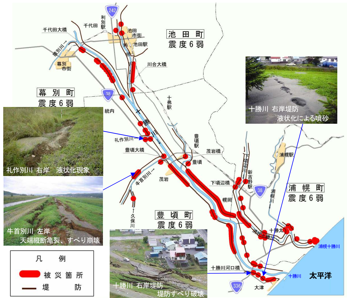
図 2-19 平成 15 年 十勝沖地震 堤防の被害状況
