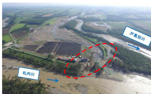
堤防一部流出 (KP40.5 左岸、平成 28 年 9 月) 堤防決壊 (KP25.0 左岸、平成 28 年 9 月)
