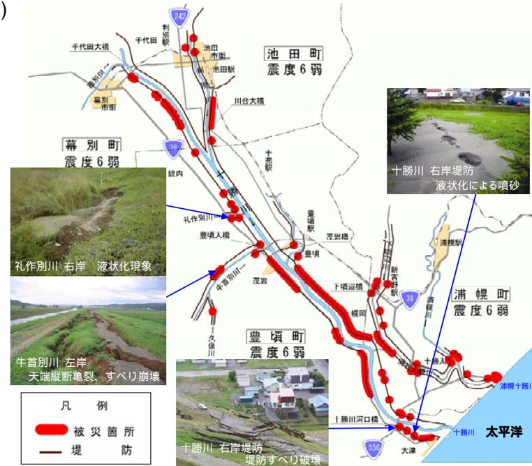
図 1-16 平成 15 年 十勝沖地震 堤防の被害状況
