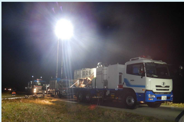
排水ポンプ車
