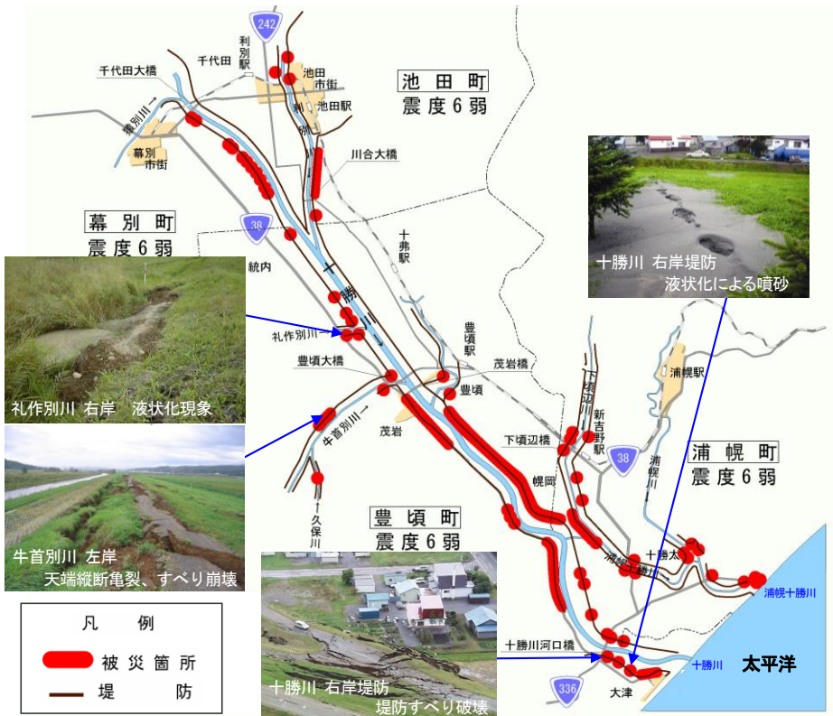
図 1-19 平成 15 年 (2003 年) 十勝沖地震 堤防の被害状況
