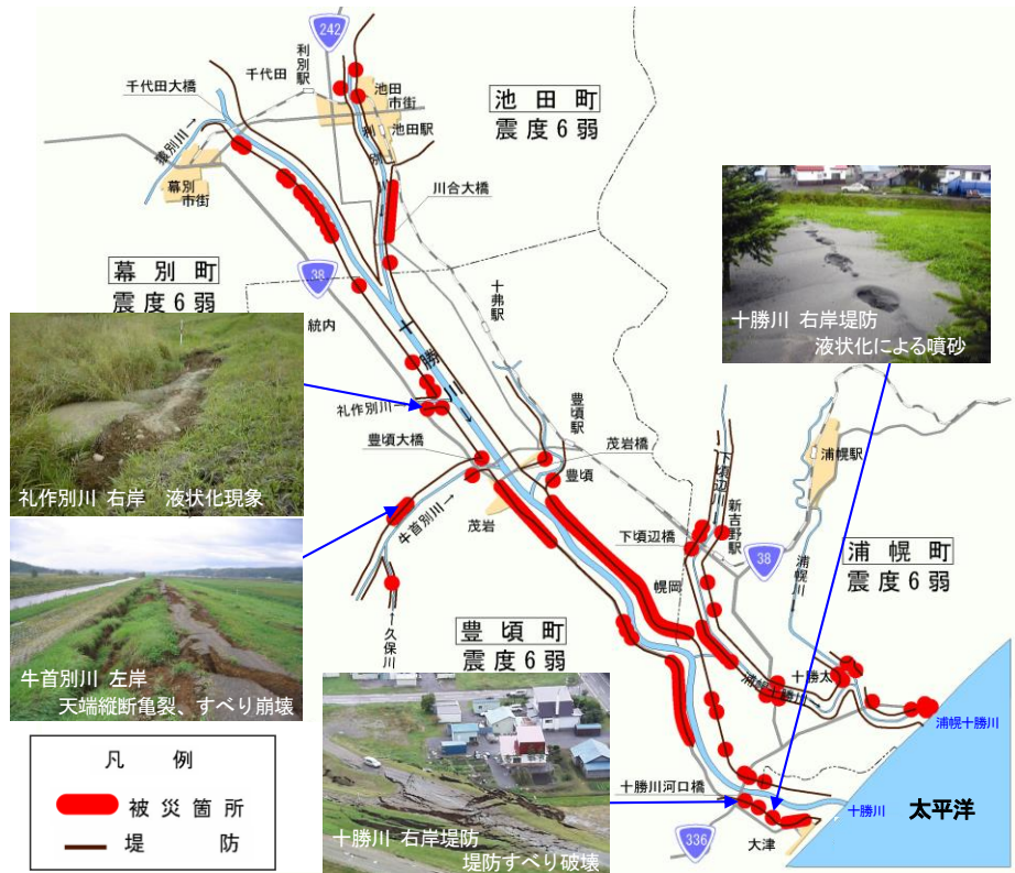
図 1-16 平成 15 年 十勝沖地震 堤防の被害状況
