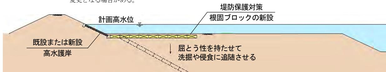
図 2-6 堤防の保護対策のイメージ図
