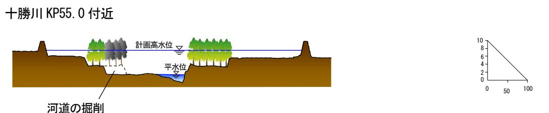
図 2-3 河道の掘削のイメージ図（十勝川）
