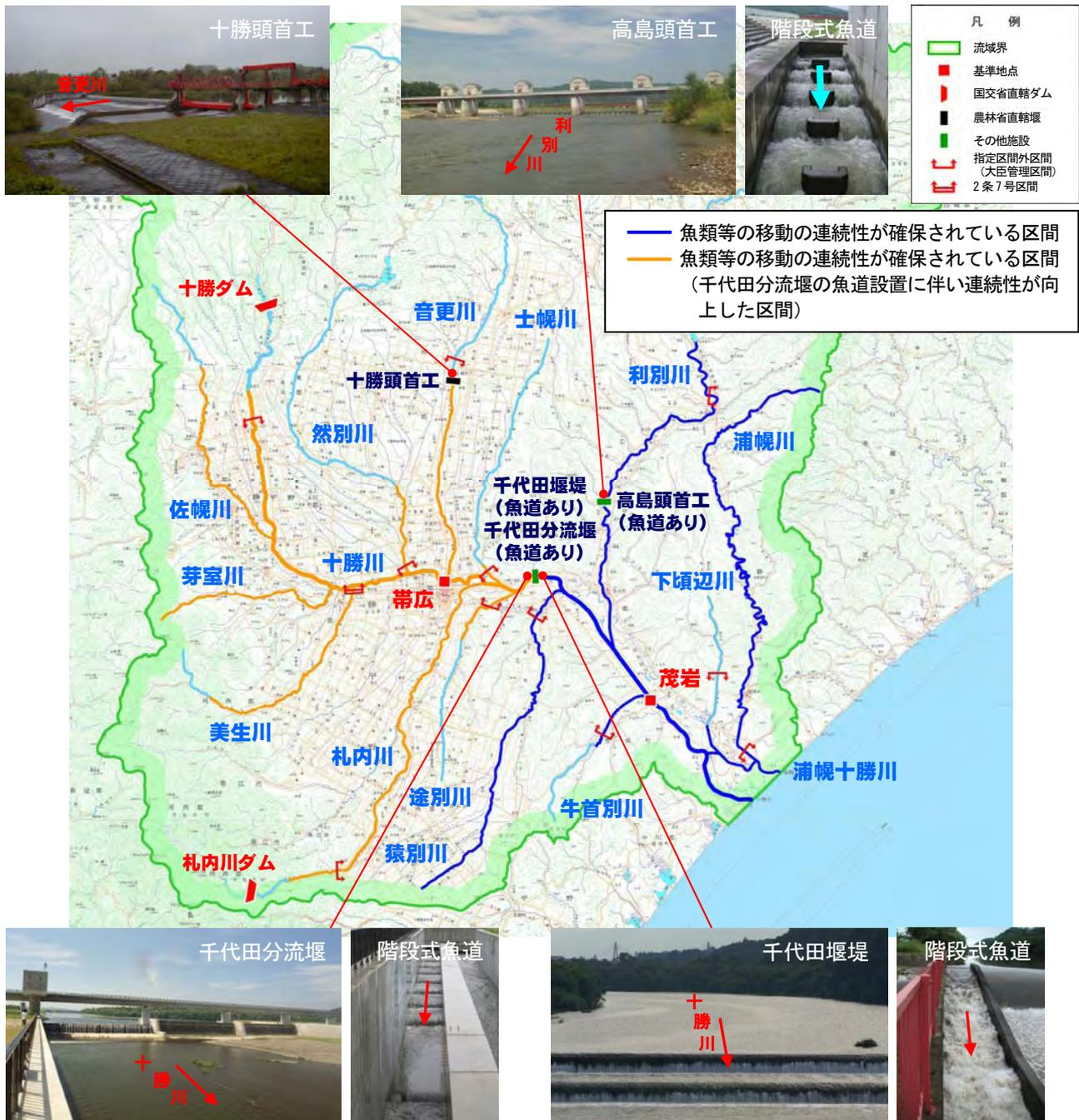
※河川横断工造物の内、「計画落差高50cm以上で魚道がない」もしくは「取水堰は可動堰であっても魚道が付いてない」施設において魚類の遡上が阻害されていると判断し、魚類等の移動の連続性が確保されている区間を設定した。
