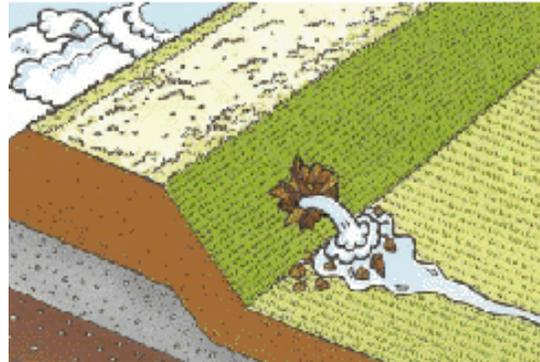
漏水を防ぐ水防工法
