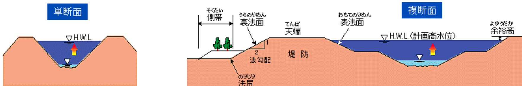
**側帯（そくたい）**：堤防を安定させるため、または非常用の土砂などを備蓄したり環境を保全するために、堤防の裏側（堤内地側）に土砂を積み上げた部分のことです。
