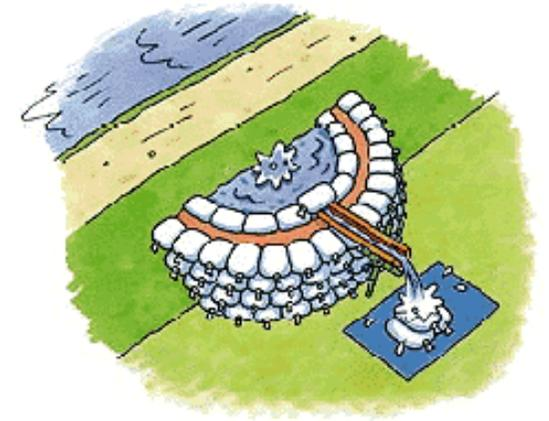
**越水**：増水した河川の水が堤防の高さを越えてあふれ出す状態のことです。あふれた水が堤防の裏法を削り、破堤を引き起こすことがあります。
