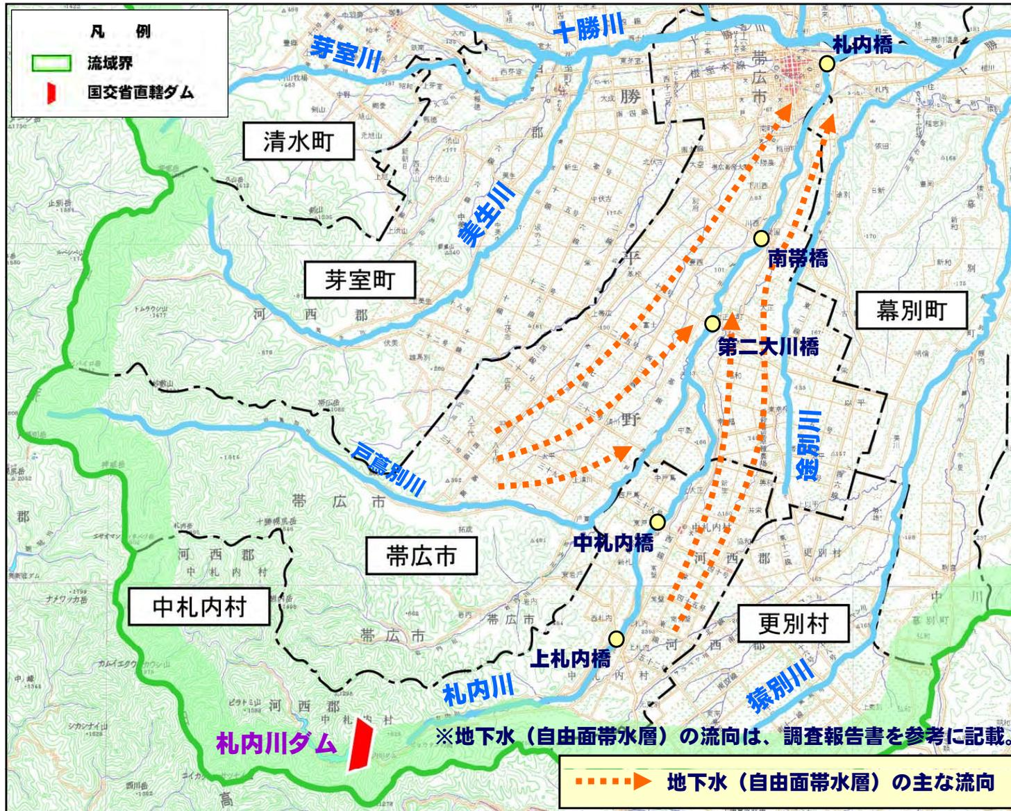
札内川周辺の地下水（自由面帯水層）の流れ
