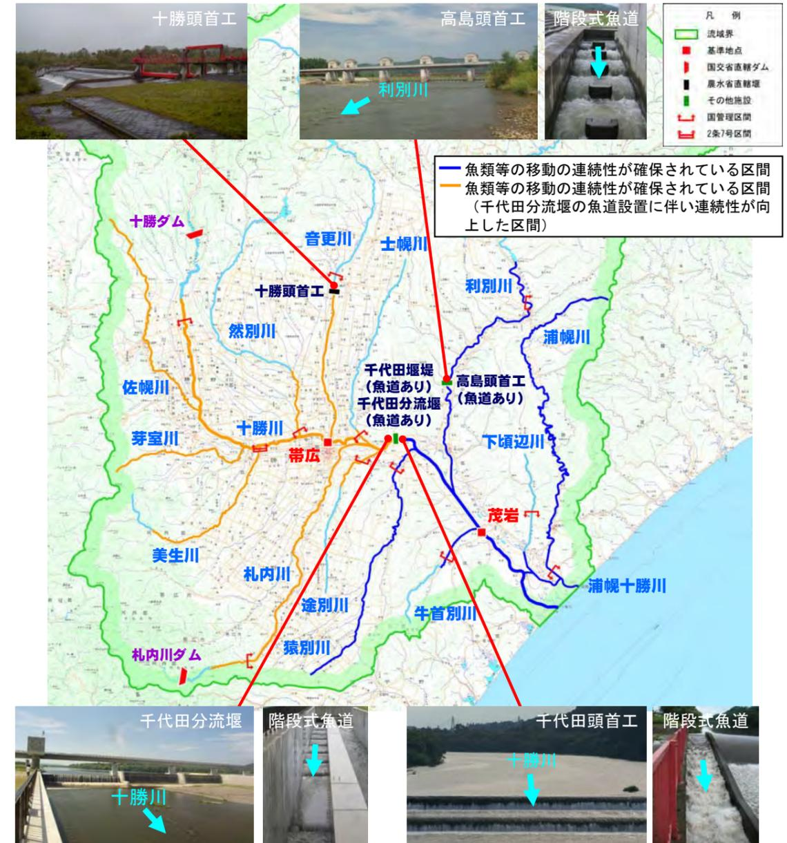
※河川横断工作物の内、「計画落差高50cm以上で魚道がない」もしくは「取水堰は可動堰であっても魚道が付いてない」施設において魚類の遡上が阻害されていると判断し、魚類等の移動の連続性が確保されている区間を設定した。
