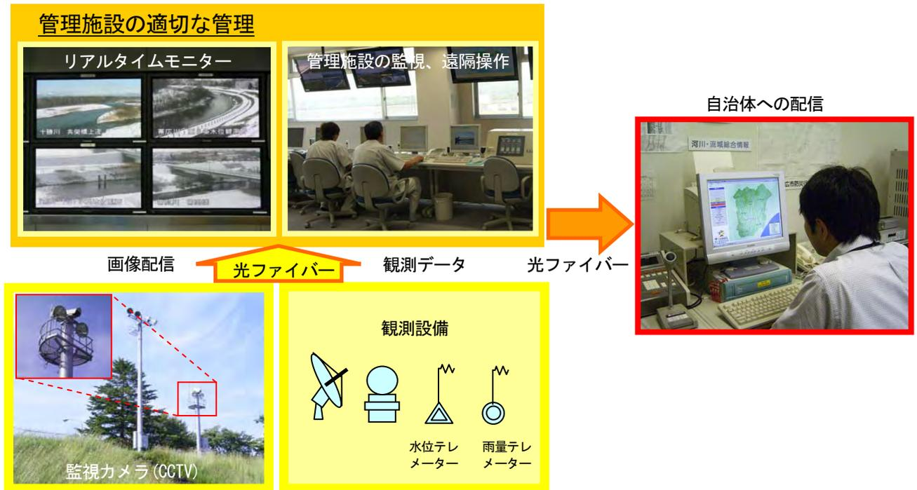
図 2-12 光ファイバー網による河川情報の収集・伝達のイメージ図
