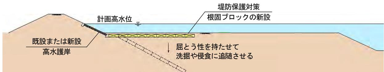
図 2-6 堤防の保護対策のイメージ図
