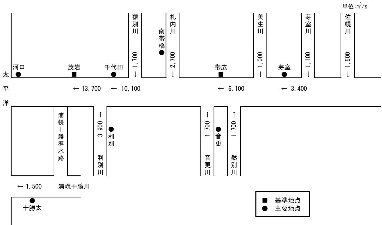
図 1-14 十勝川水系河川整備基本方針における十勝川計画高水流量配分図(単位 : m<sup>3</sup>/s)
