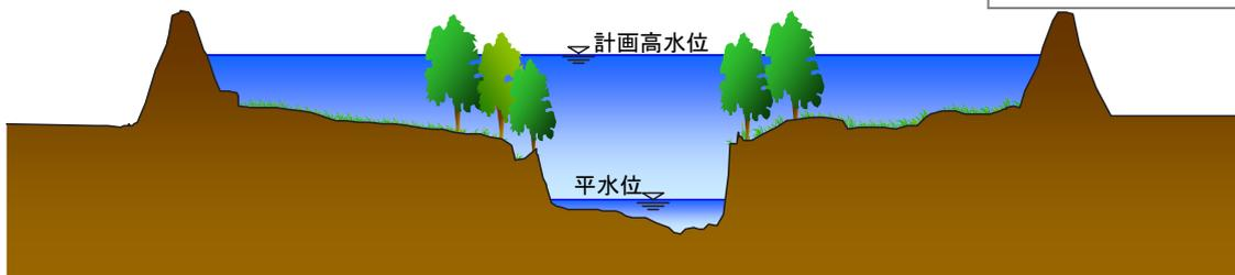
洪水流下の支障となる樹木が繁茂すると、河積が小さくなり水位が上昇する。
